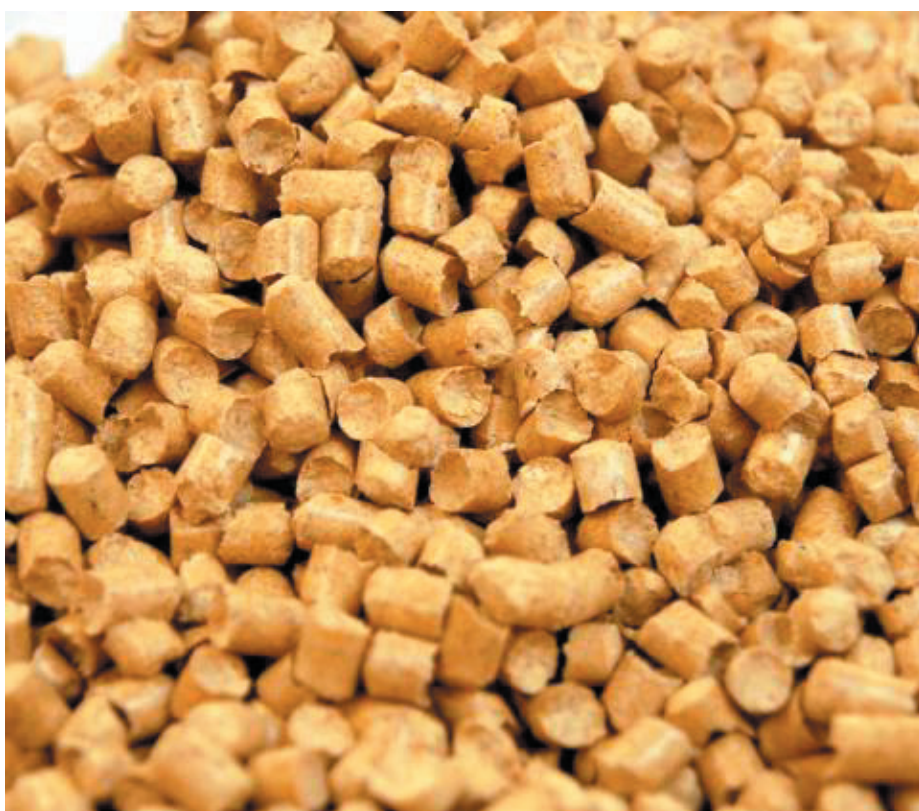
13: ... til at hænge sammen som en spånplade, men uden brug af lim.
