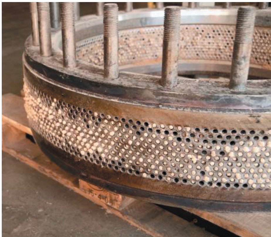
11: ... presser træfibrene ud igennem de tusinder af små huller. Varme og tryk får fibrene ...
