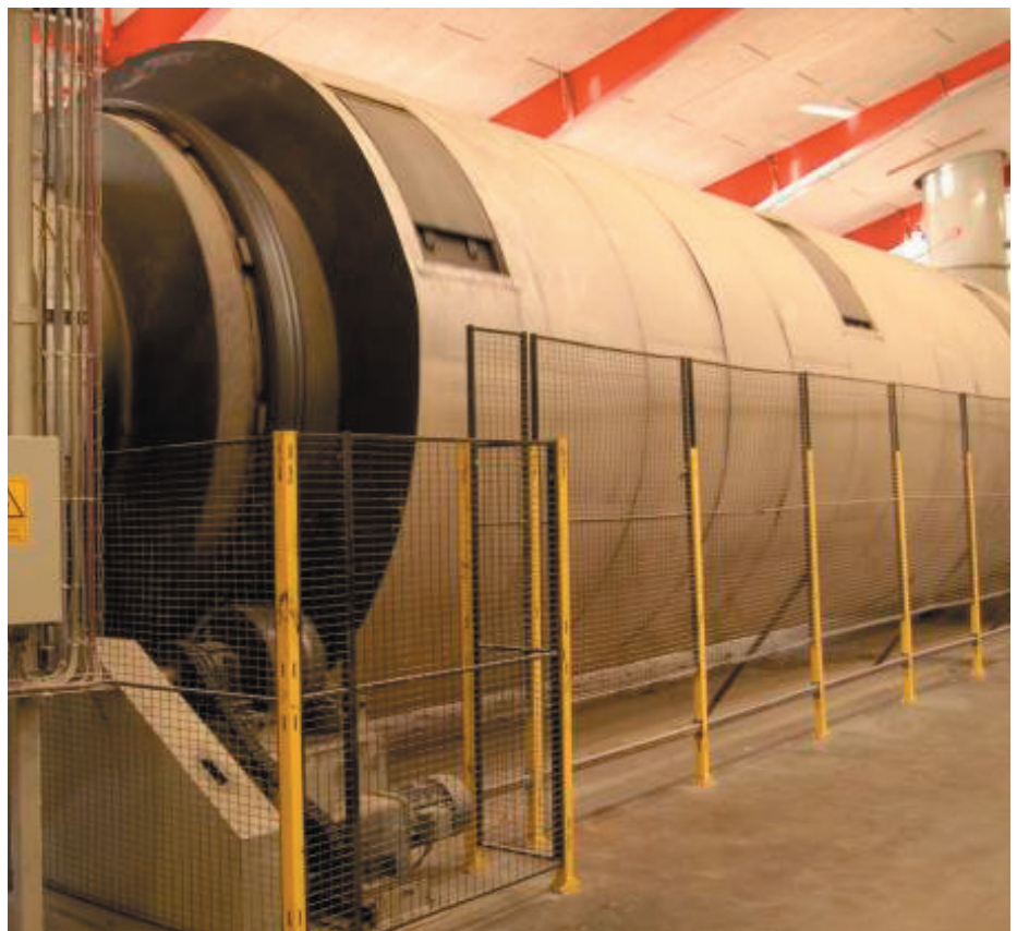
8: De våde spåner hældes ind i den roterende ovn, som holdes varm af røggassen fra ...
